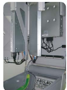
Sichere Montage und voller Zugriff auf alle 1HE und 2HE Komponenten.
